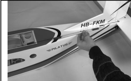
On peut voir sur cette photo, la tringlerie de direction assemblée, présentée à l'extérieur du fuselage, dans la position qu'elle doit occuper à l'intérieur du fuselage.
