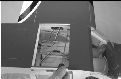
● Monter les ailes: elles sont serrées contre le fuselage à l'aide de 2 vis BTR 2-2.
