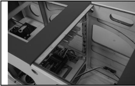
● Utiliser un terminal de connection (#0434070) pour pouvoir brancher facilement les rallonges des servos d'ailes.
