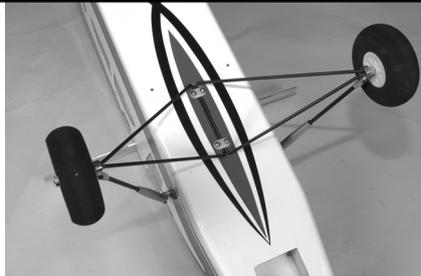
● Protéger avec de la résine époxy, le bois à nu sous le fuselage à l'endroit de fixation du train.
