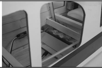
● Positionner l'accu dans le fuselage en fonction du centrage. L'envelopper dans de la mousse et le fixer solidement.
