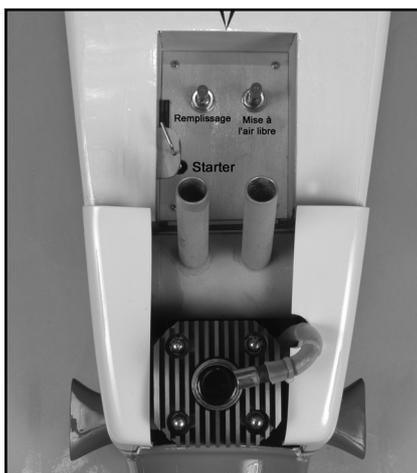
● Installer les sorties remplissage et mise à l'air libre du réservoir sur la trappe
