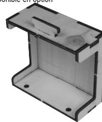
● Installer le module d'allumage derrière la cloison pare-feu. Nous nous servons du kit #06614-1A pour cela. L'ensemble est collé contre le flanc gauche du fuselage. Le module est facilement démontable à travers la trappe
