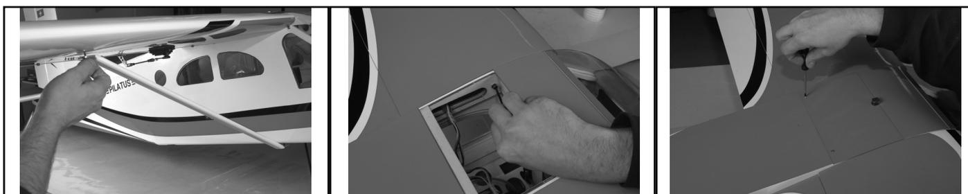
●Fixer les haubans 2-1 avec les 4 vis (prévoir des rondelles éventail pour éviter que les vis ne se déserrtent en vol!)
