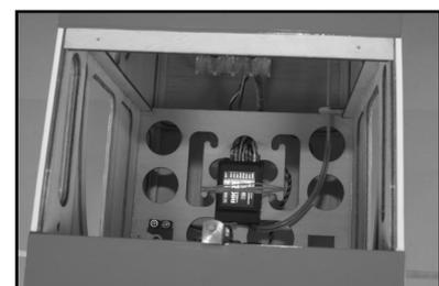
● Utiliser un terminal de connection #0434071 pour brancher facilement les servos d'ailes (accessibilité et code couleur).
