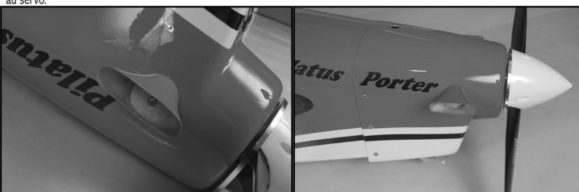
● Coller les 2 tuyères factices 9T: cette opération pourra être facilitée en façonnant 2 rondelles en balsa collées à l'intérieur des tuyères et elles mêmes collées-vissées sur le capot.
