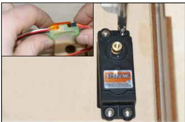
7) Installer le servo de dirigeabilité de la roue avant sur sa platine dans le fuselage (à droite).
