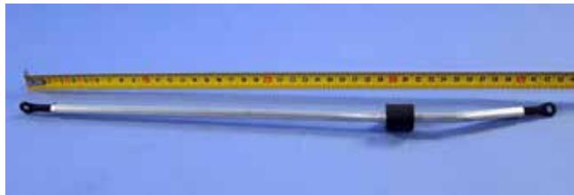
11) Enfiler la commande de dirigibilité par le trou déjà percé à droite de la cloison pare-feu, la glisser sous le plancher du réservoir et la brancher sur le servo de dirigibilité comme montré.
