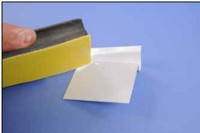
6) Dépolir la trappe support du servo de direction à l'endroit du collage des blocs bois dur.
