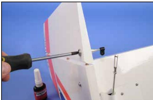
17) Fixer le guignol de direction H en place. Le trou est déjà pré-percé dans le volet de dérive.
