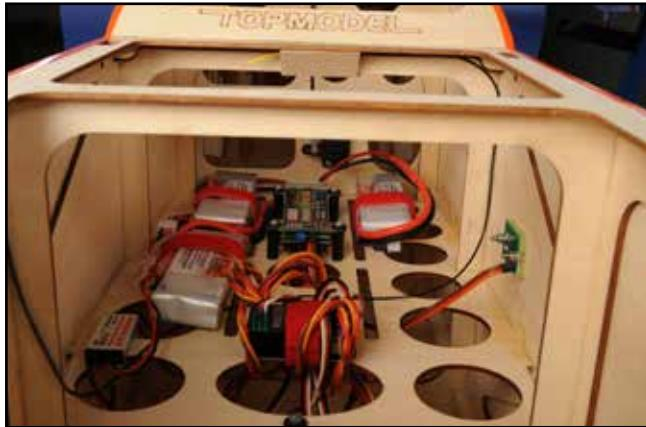
1) En fonction du centrage, installer le régulateur-doubleur d'accus JETI MAX BEC 2D, le récepteur et les accus de réception.
