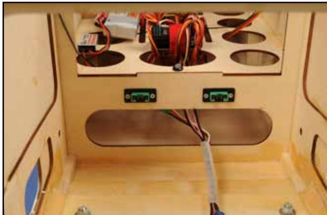
2) Nous utilisons des connecteurs MG6 (MPX) montés sur leur support (# O2ONES001) pour connecter facilement et efficacement les servos d'ailes (ailerons et volets).
