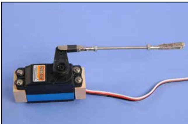
7) Monter la tringlerie de direction G sur le servo.
