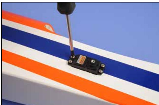
3) Monter les servos de profondeur dans leur emplacement de chaque côté du fuselage, à l'arrière.
