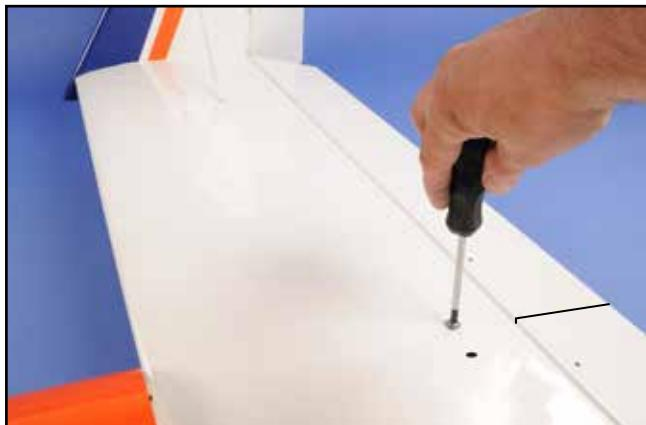
7) Monter le stab. sur le fuselage (2 têtons à l'avant+2 vis à l'arrière).
