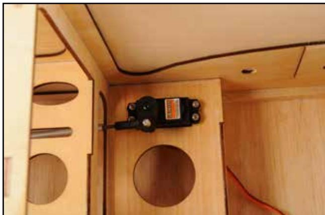
12) Brancher la commande de dirigibilité sur le bras de la roue avant. Ajuster le neutre.
