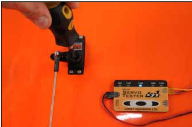
13) Assembler la tringlerie d'aileron B comme sur la photo. Régler les chapes pour obtenir une longueur de 170mm environ.
