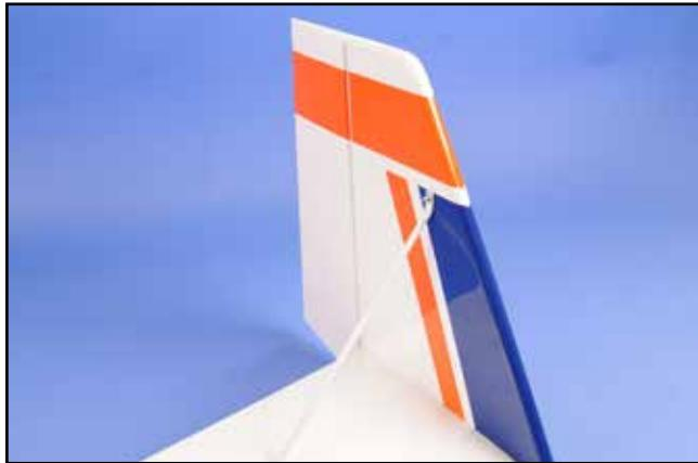
... et dans la dérive avec la vis + écrou et rondelle.
