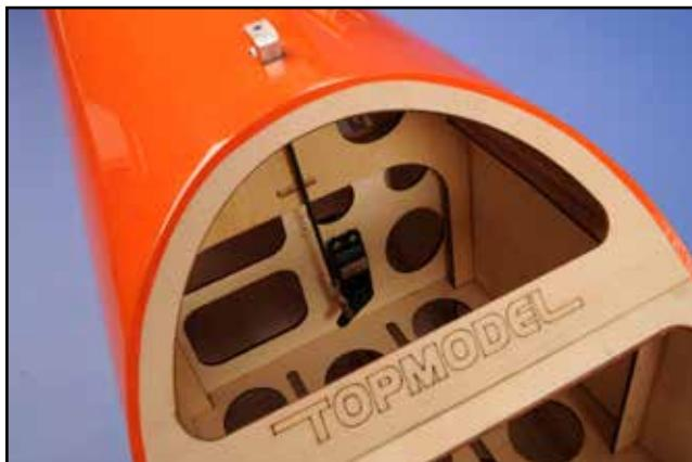
1) Monter le servo du crochet de remorquage et le crochét dans leur emplacement, dans la position montrée sur la photo.
