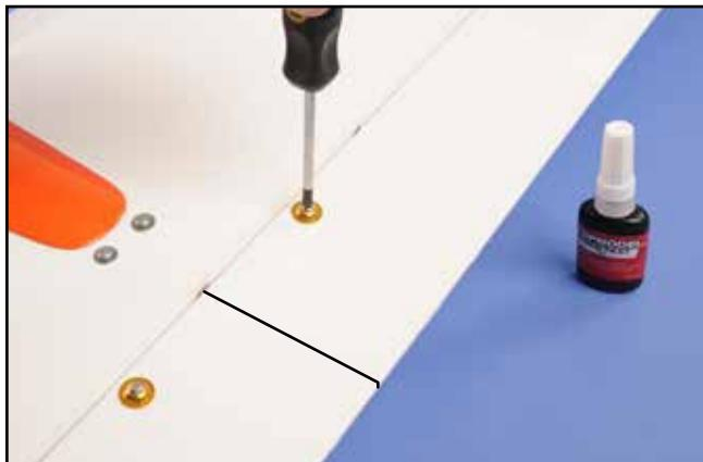
10) Installer les guignols de profondeur E en place. Les trous sont déjà pré-percés à l'usine. Visser l'écrou puis la partie plastique. Ne pas oublier d'intercaler les rondelles d'appui spéciales.
