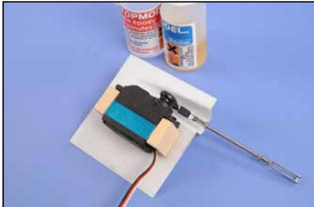
8) Présenter à blanc le servo de direction équipé de sa tringlerie G. Centrer la tringlerie dans sa sortie de commande, comme sur la photo.
