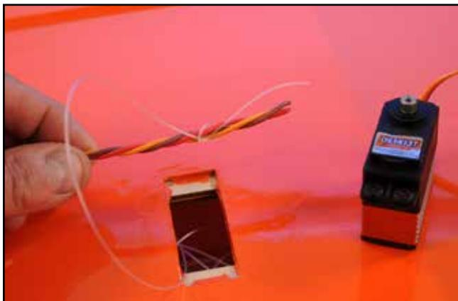
4) Attacher les rallonges solidement avec les cordelettes déjà passées dans l'aile.
