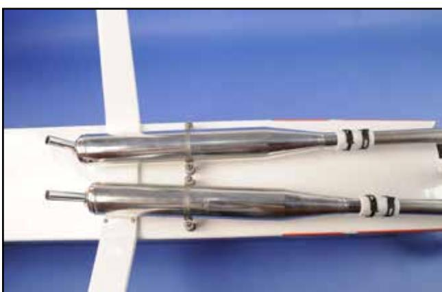
10) Monter les échappements. Nous utilisons des pipes en L KS, que nous coupions à la bonne longueur et avec un angle (pour que le réso passe sous le ventre de l'avion) puis brasons une bride.
