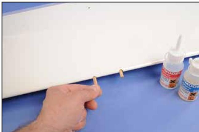
2) Coller à la colle époxy 5mn, les tétons A de fixation du stab. Les trous sont déjà pré-percés à l'usine.
