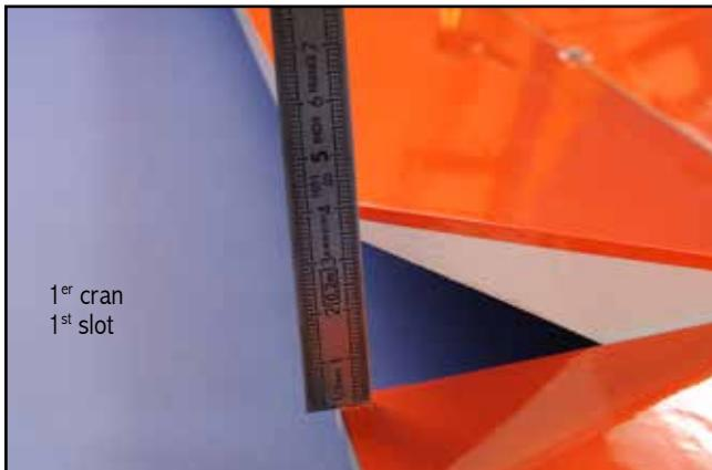
18) Connecter la tringlerie. Le volet doit être baissé de **30mm** vers le bas (1er cran) quand le servo est au neutre.
