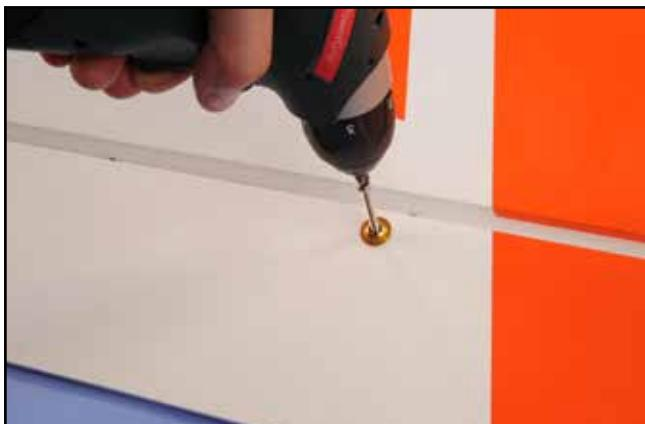
11) Après avoir repéré le trou percé à l'usine pour le guignol d'aileron, percer l'entoilage puis visser la vis sans oublier d'enfiler la rondelle d'appui spéciale comme montré sur la photo.
