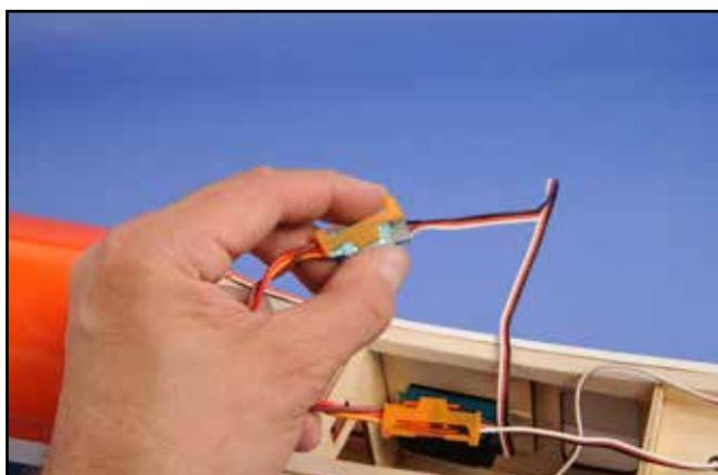
5) Connecter une rallonge de 115cm de long sur chaque servo de profondeur. Préférer des rallonges en fils torsadés. Assurer les connexions avec des sécurités connecteurs #0434085.
