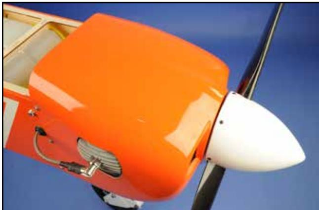
13) Repérer les trous pour la fixation du capot. Ajuster puis monter le capot sur le fuselage à l'aide des 6 vis C.
