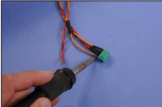
9) Souder les 2 rallonges (servo aileron et volet) sur la prise MG6 (MPX).
