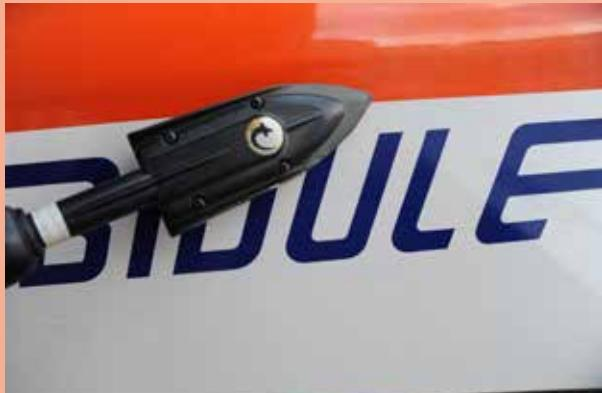
2) En utilisant un fer à soler et un chiffon doux, "repassez" délicatement et "suivez" en appliquant le film avec le chiffon. Si des bulles apparaissent, votre fer est peut être trop chaud. Réduire la température et travaillez doucement et patiemment.
