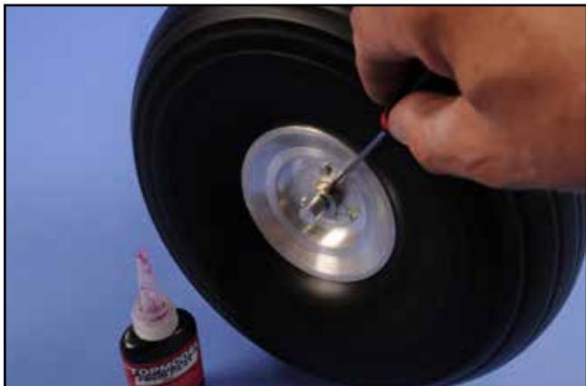
4) Monter les roues I (bague d'arrêt de chaque côté). Notez l'utilisation de frein-filet.
